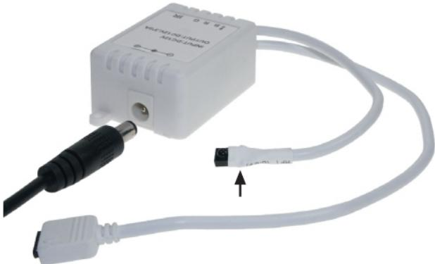
Let er a.u.b. op dat de tweede kabel (die op de bovenstaande afbeelding met de blauwe pijl gemaarkeerd is) niet gemonteerd mag worden: het betreft hier de infraroodontvanger, die op de commando's van de afstandsbediening reageert. Gelieve deze binnen bereik van de afstandsbediening te laten (ongeveer 5 tot maximaal 10 m!)
