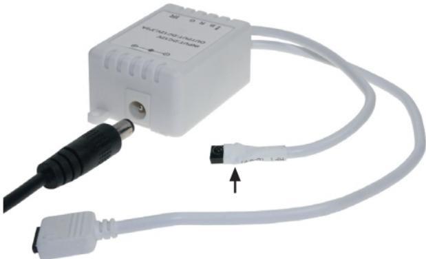
Lägg märke till att den andra kabeln (som kännetecknas på övre bilden med pilen), inte får installeras inbyggd eller dold. Detta är den infraröda(IR) mottagaren, som reagerar på kommandon från fjärrkontrollen. Som med en radio måste IR-styrenheten och fjärrkontrollen vara synliga.
