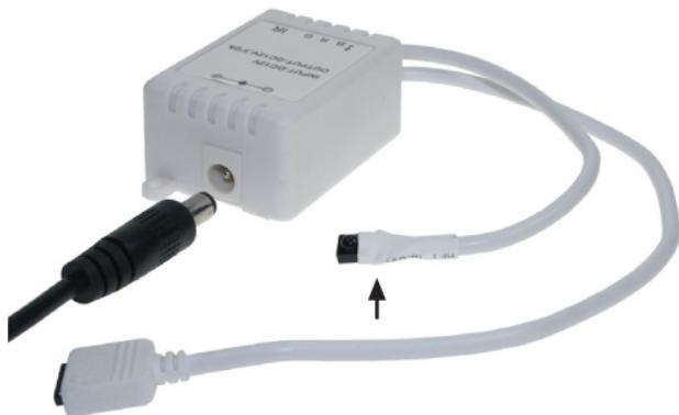
Rețineți faptul că al doilea cablu (care este marcat cu o săgeată în imaginea de mai sus) nu trebuie să fie integrat sau montat ascuns. Aceasta este receptorul infraroșu (IR), care răspunde la comenziile telecomenzii. Ca și releele radio (radio direcțional = radio vizibil), între controlerul IR și telecomandă trebuie să existe o comunicare neobstrucționată. Rază de acțiune: 3 până la max. 5 m
