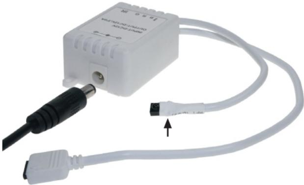
Beachten Sie, dass das zweite Kabel (welches auf dem oberen Bild mit dem Pfeil gekennzeichnet ist), nicht eingebaut oder versteckt angebracht werden darf. Es handelt sich um den Infrarot-Empfänger (IR), der auf die Befehle der Fernbedienung reagiert. Wie beim Richtfunk (Richtfunk = Sichtfunk) muss der IR-Controller und die Fernbedienung sichtbar sein. Reichweite: 3 bis max. 5 m
