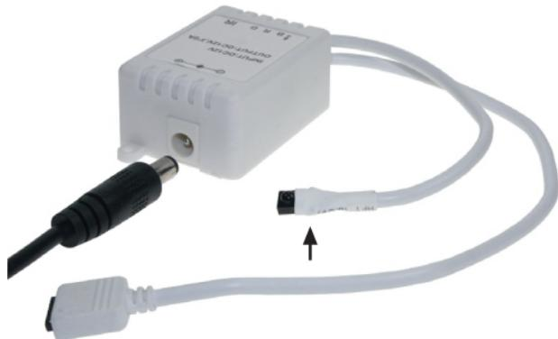
Rețineți faptul că al doilea cablu (care este marcat cu o săgeată în imaginea de mai sus) nu trebuie să fie integrat sau montat ascuns. Aceasta este receptorul infraroșu (IR), care răspunde la comenziile telecomenzii. Ca și releele radio (radio direcțional = radio vizibil), între controlerul IR și telecomandă trebuie să existe o comunicare neobstrucționată. Rază de acțiune: 5 până la max. 10 m
