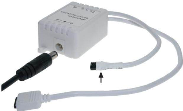
Beachten Sie, dass das zweite Kabel (welches auf dem oberen Bild mit dem Pfeil gekennzeichnet ist), nicht eingebaut oder versteckt angebracht werden darf. Es handelt sich um den Infrarot-Empfänger (IR), der auf die Befehle der Fernbedienung reagiert. Wie beim Richtfunk (Richtfunk = Sichtfunk) muss der IR-Controller und die Fernbedienung sichtbar sein. Reichweite: 5 bis max. 10 m
