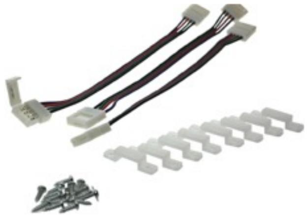
Mit diesem SET können bereits geschnittene LED Streifen werkzeuglos wieder miteinander verbunden werden. Der Streifen wird in den Crimpstecker eingelegt und mit der dazugehörigen Kappe fest eingedrückt. Die kleinen Crimpkontakte werden durch die flexiblen Leiterbahnen gestossen und sichern somit den Kontakt. Inhalt: 3 Verbindungskabel, 15 cm Länge, sowie 8 x Silikonschellen und Schrauben
